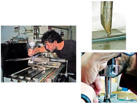
Bild 3: Probennahme aus den Klingen in der mechanischen Werkstatt der Universität Complutense in Madrid.
