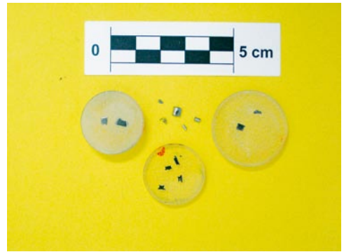
Bild 4: Photographie einiger der zur weiteren Behandlung schon in Harz gegossener Proben.
