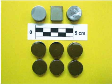
Bild 5: Photographie der für die Nachbehandlung im Labor präparierten modernen Stahlproben CK-75.
